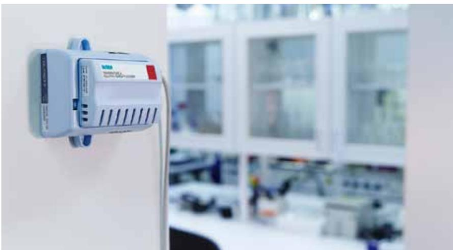
Facili da installare, i dispositivi di monitoraggio si autoidentificano all'interno del software viewLinc e vengono forniti con semplici modelli di configurazione.
