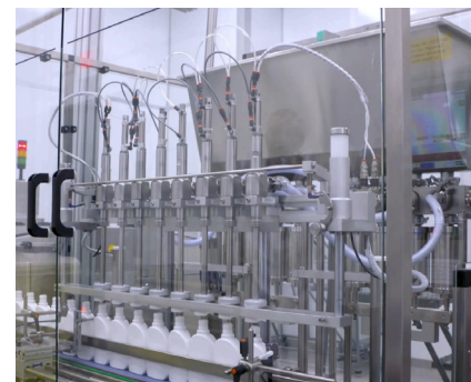
Dispositivo di riempimento linea 10
