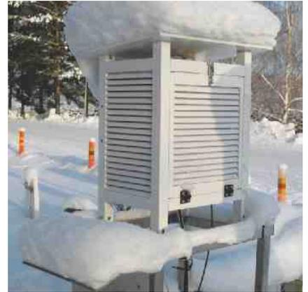
图2: 安装在芬兰万塔维萨拉测试场地百叶箱内的两只HUMICAP®仪表。另外,也使用了传感器化学清除功能。
